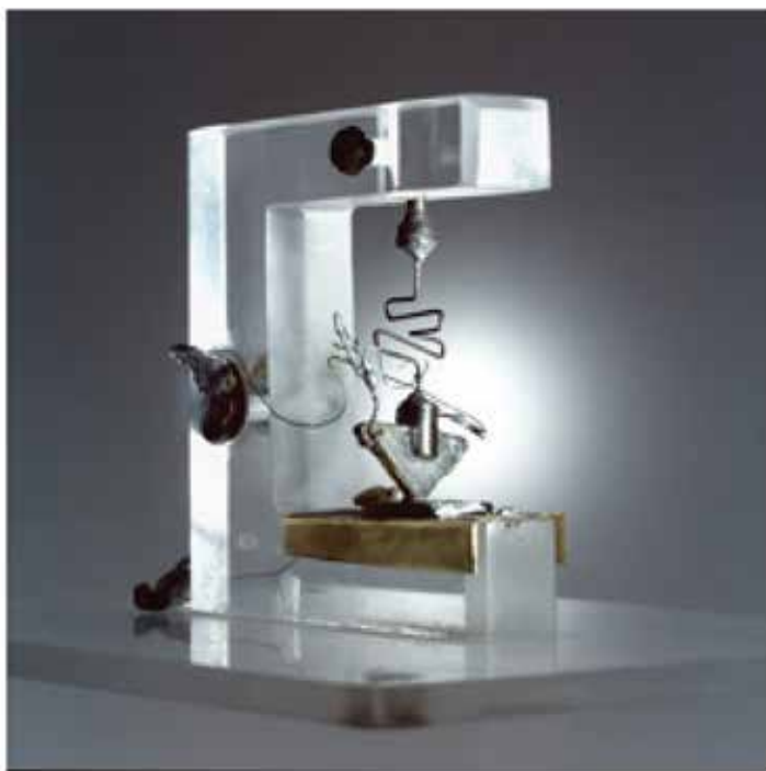
Figura 20. Montagem experimental do primeiro semiconductor: A placa triangular é um monocristal de germânio sobre a qual temos um eletrodo de ouro, o catodo, e na parte inferior outro eletrodo do mesmo material, o anodo. Ao aplicar uma voltagem alternada entre o anodo e o catodo observa-se a retificação da corrente.
